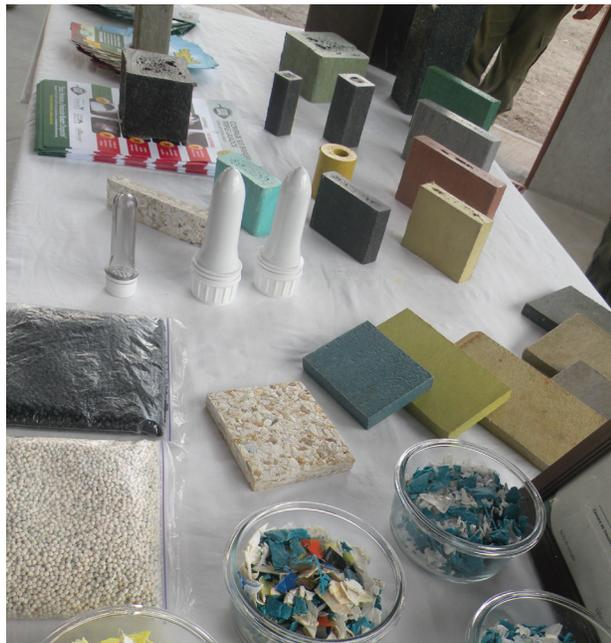
Diferentes materiales que se obtienen a partir del plástico reciclado.
