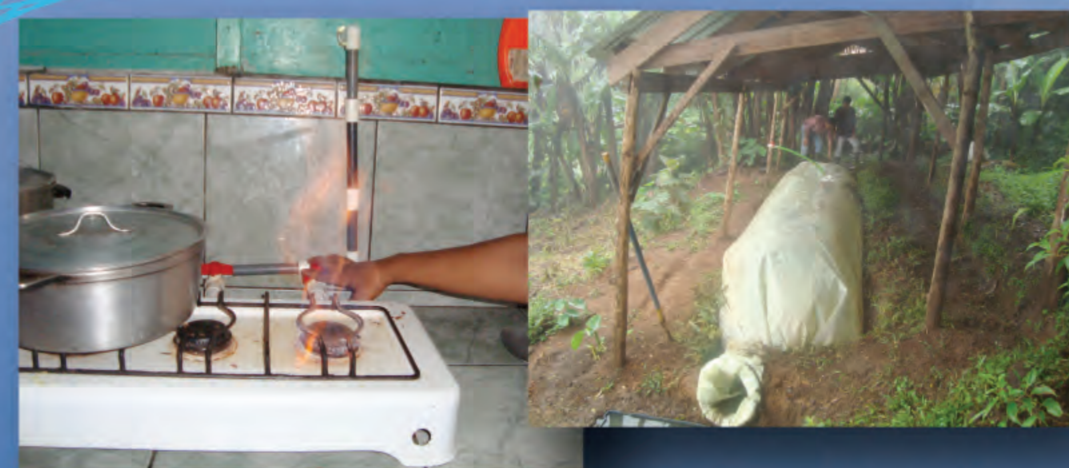
La familia Ovaes en Asent. Río Negro, Cobano, cocina con biogás Biodigestor en parcela Familia Chaves
