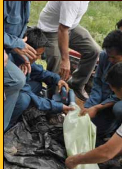
Foto 14. Se procede a inflar la doble bolsa plástica, en este caso utilizando una sopladora eléctrica.
