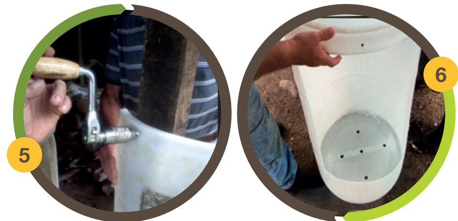
Figuras 5 y 6: Perforado de huecos en la puerta y en el fondo del estañón.
