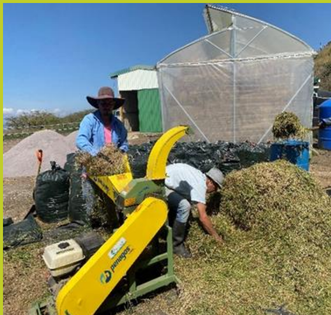
Figura 2. Proceso de picado de pasto para ensilado
