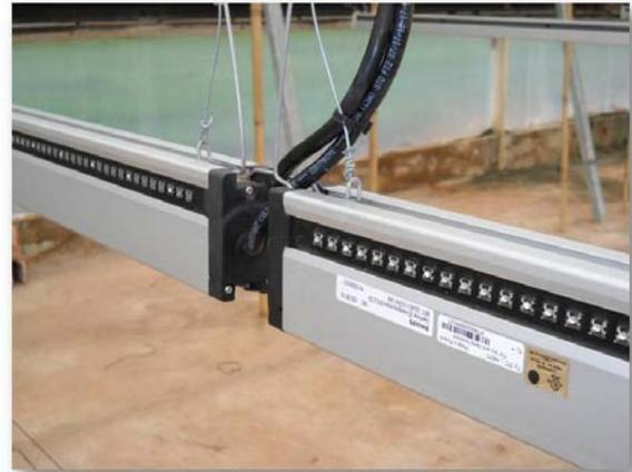
Figura 1. Dispositivo emisor con batería de diodos
