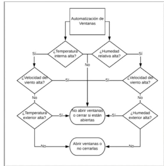
Figura 3. Esquema de automatización de un proceso.
