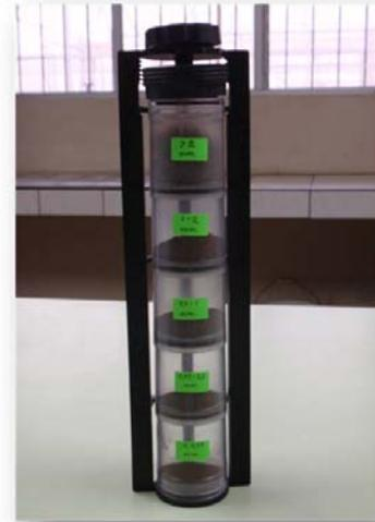
Figura 1. Instrumento (criba mecánica) utilizado para separar las partículas de los sustratos por su tamaño.
