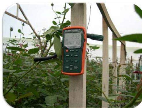
Figura 1. Toma de datos sobre niveles de CO<sub>2</sub>, temperatura y humedad relativa en el invernadero de rosas en Llano Grande de Cartago.
