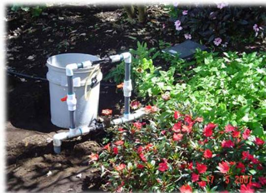
Figura 2. Aplicación con el aditamento Venturi.
