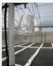
Vista del ensayo y de un sensor de temperatura protegido
