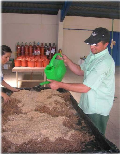
Figura 1. Preparación de la mezcla con serrín y fibra de hoja de palma aceitera.
