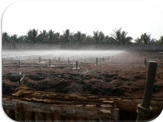
Figura 3. Proceso de lavado en origen, con aspersores.
