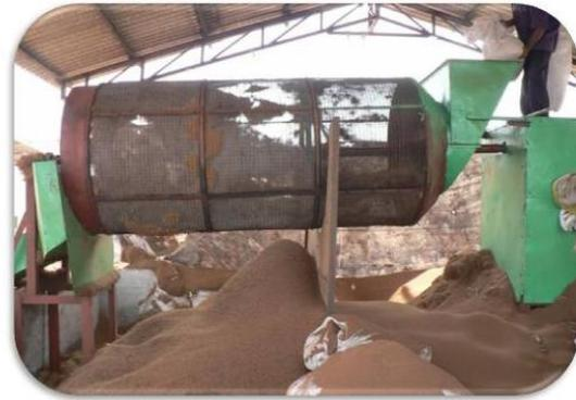
Figura 4. Detalles de criba de grano de coco. En la parte baja, material fuera de especificación.
