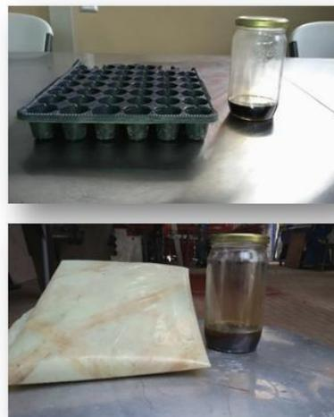
Figura 2. Ejemplo de subproducto líquido logrado mediante la pirólisis.
