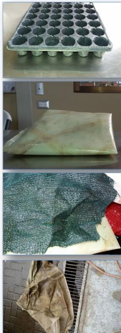
Figura 1. Materiales de cerramiento tratados en el proceso de pirólisis. De arriba hacia abajo, bandejas para plántulas, plástico de techo, sarán y malla anti-insectos.
