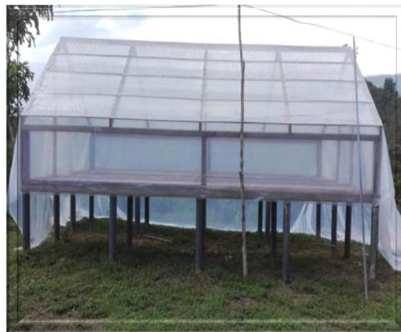
**Figura 4.** Secador de cacao construido por el grupo
