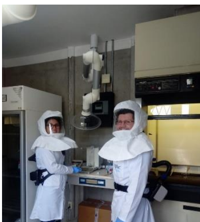
Ilustración 2 Equipo de seguridad especializado y brazo extractor.
