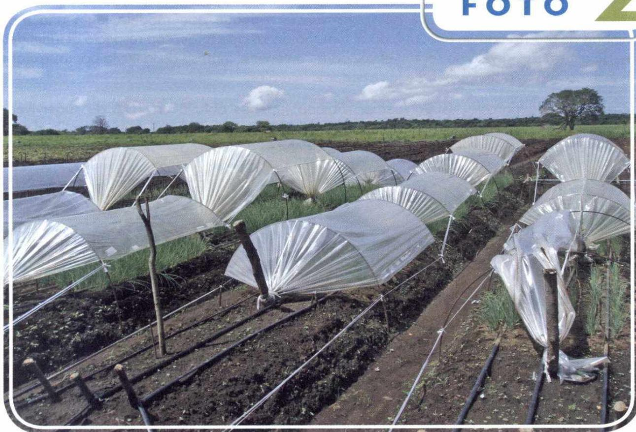
Ensayo establecido por el INTA sobre alturas de túneles para evaluar condiciones ambientales internas y su efecto en el desarrollo de almácigos de cebolla. Cañas, Guanacaste, oct. 2007.
