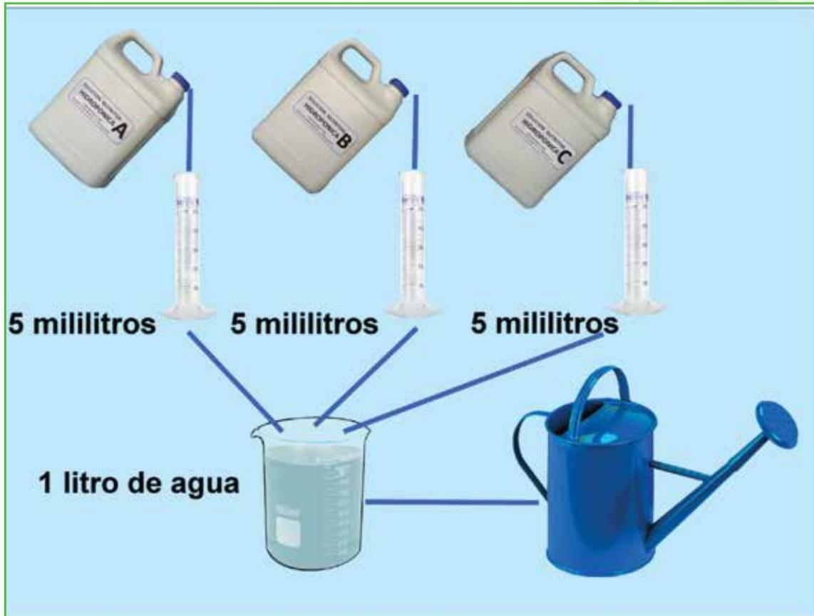
**Figura 9.** Preparación de solución nutritiva diluida para riego a partir de soluciones concentradas A, B y C.
