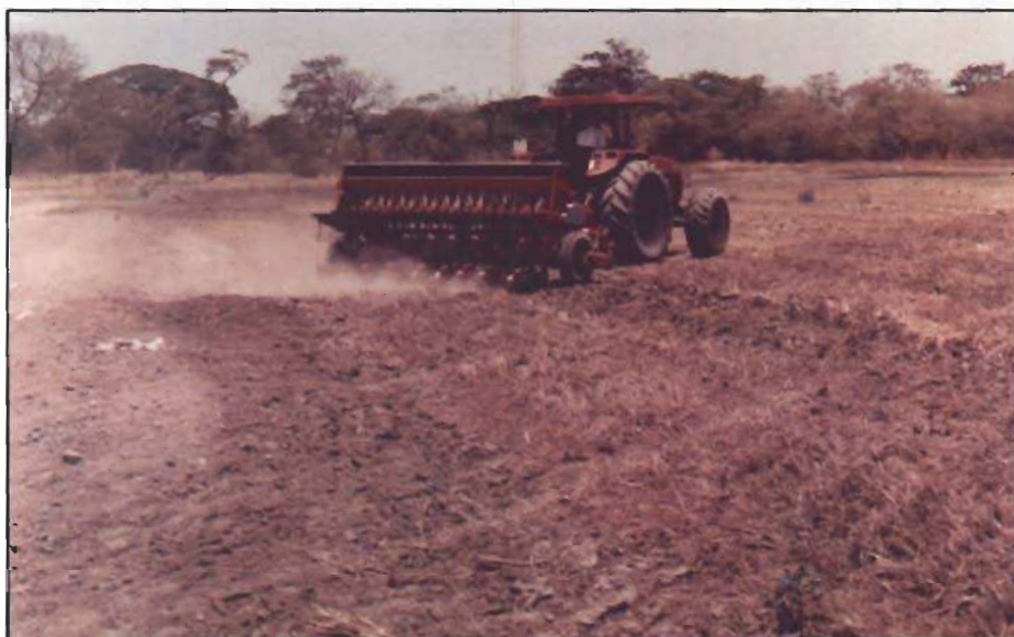
Figura 9. Establecimiento de plantación de arroz con equipo de mínima labranza
