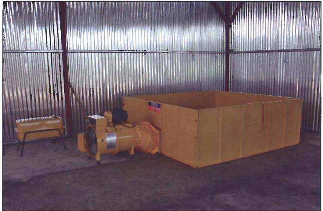
Foto 29. Secadora de granos con capacidad de 20-24 quintales
