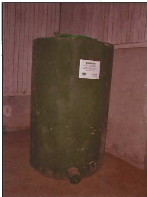
Foto 30. Silo metálico con capacidad de 8 quintales
