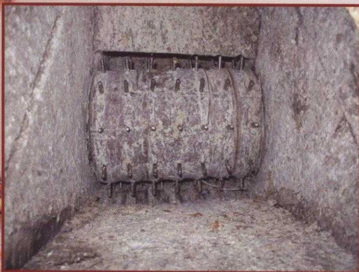
Fotografía 29 Despulpadora
