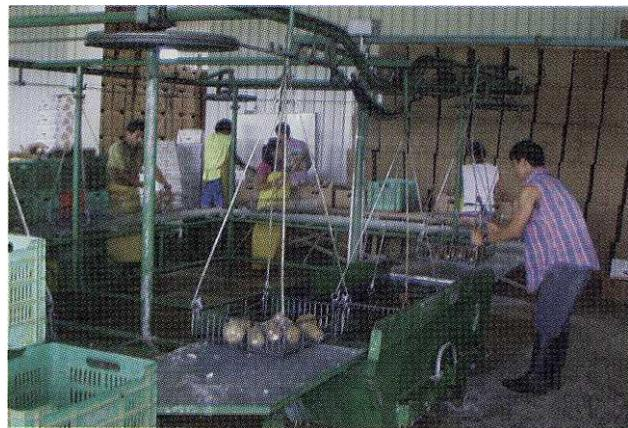
*Figuras 24 y 24.1. Parafinado de yuca de manera manual y mecanizada (sistema carrusel).*
