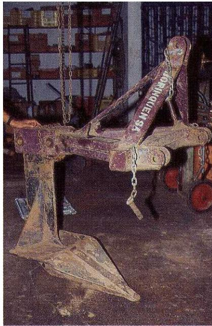
*Figura 15. Instrumento utilizado en Costa Rica para la cosecha mecánica de yuca
