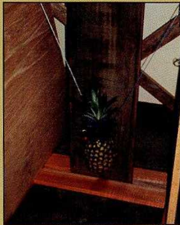
Foto N° 8: Péndulo para las pruebas de impacto con una piña sobre una superficie de almendra. La piña se sujeta de dos puntos con una cuerda.
