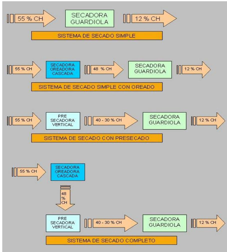
Figura 2. Sistemas de secado utilizados en Costa Rica.
