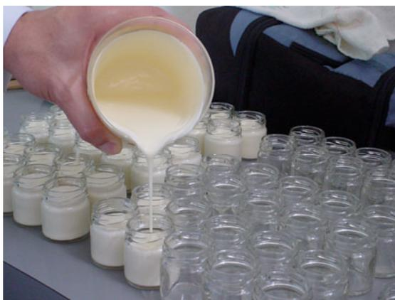
**Figura 4.** Envasado de la crema a una temperatura de 40 °C.
