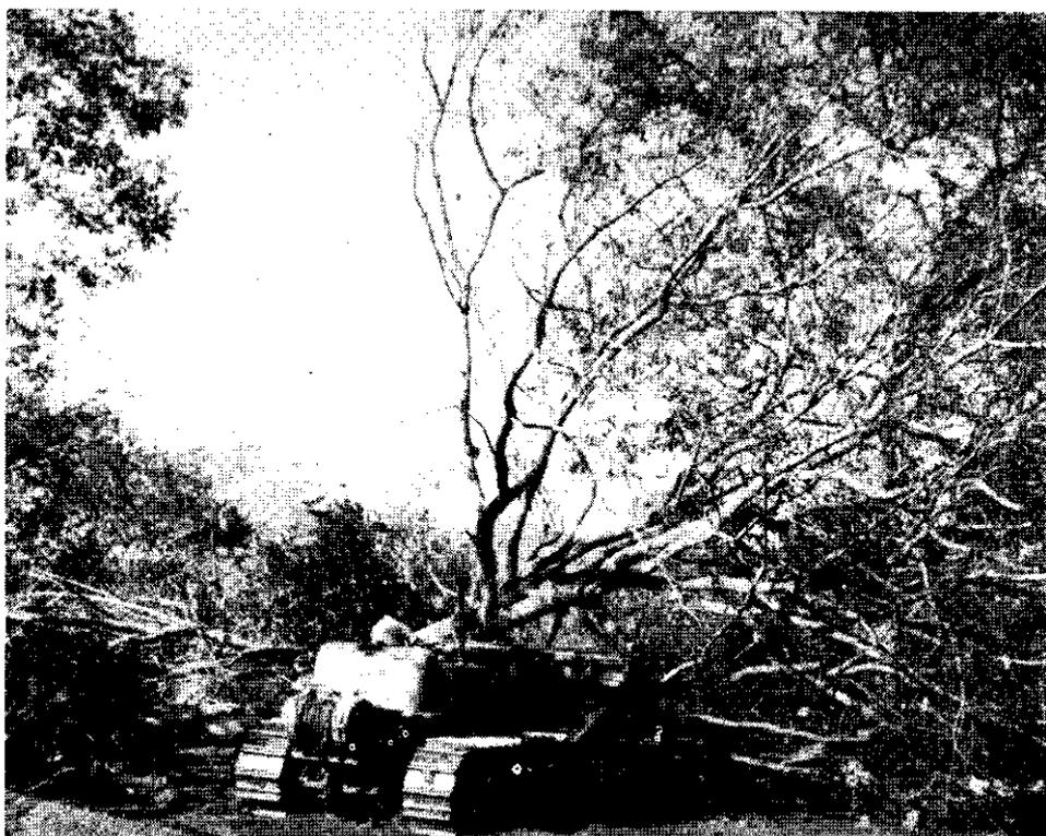
*En la preparación inicial de tierras es frecuentemente necesario remover árboles grandes que requieren máquinas pesadas. En la fotografía vemos un tractor Hd-15 en esta operación en una finca de Filadelfia, Guanacaste.*
