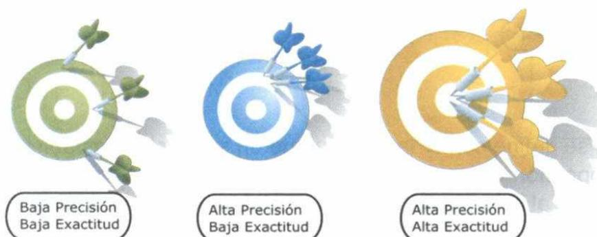
Figura 2.7. Ilustración de los conceptos de precisión y exactitud. Según Nielsen (2014).
