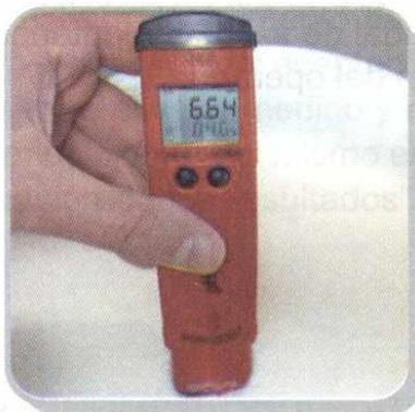
Figura 2.2. Sensor portátil de pH.
