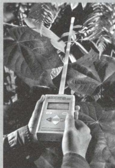
Debido a la longitud de la barra de sensores, se recomienda tener cuidado para no golpearla. Puesto que el sensor fue diseñado para uso de campo, viene con caja rígida que debe ser usada siempre para el transporte. Debe mantenerse limpio.
