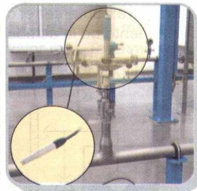
Figura 2.3. Sonda de pH para instalación en campo.
