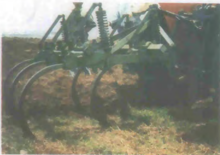
Foto No 47- Arado de cincel usado en un suelo profundo de origen volcánico
