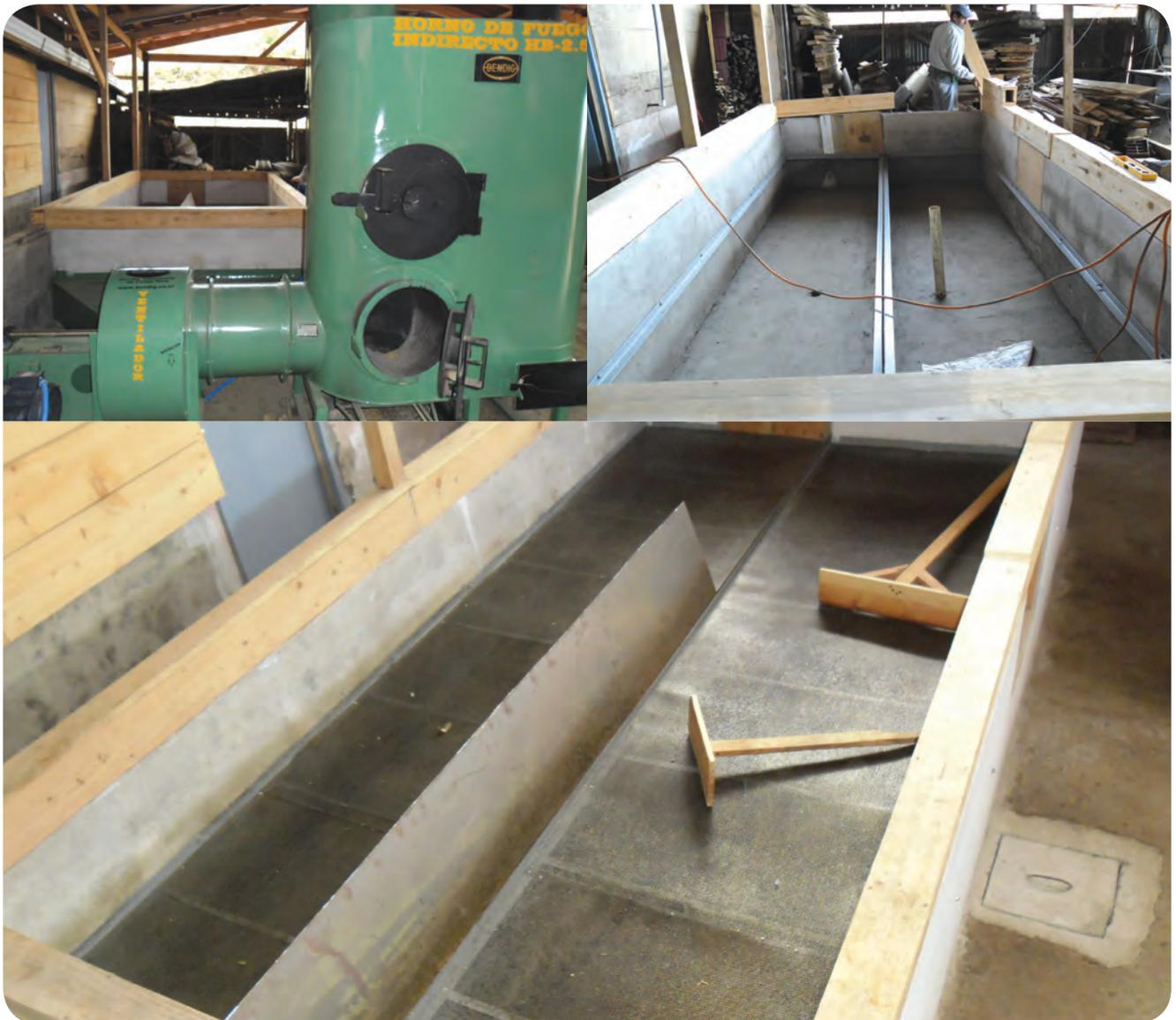
Equipo de secado mecánico con estática, construida en block y cemento para 30 fanegas.
