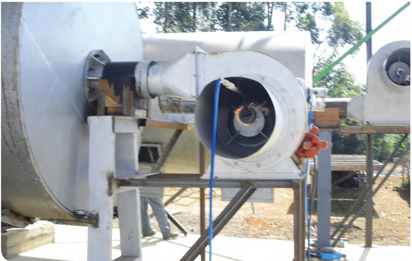
Equipo de secado con guardiola, usando como fuente de combustión gas propano para la producción de calor.
