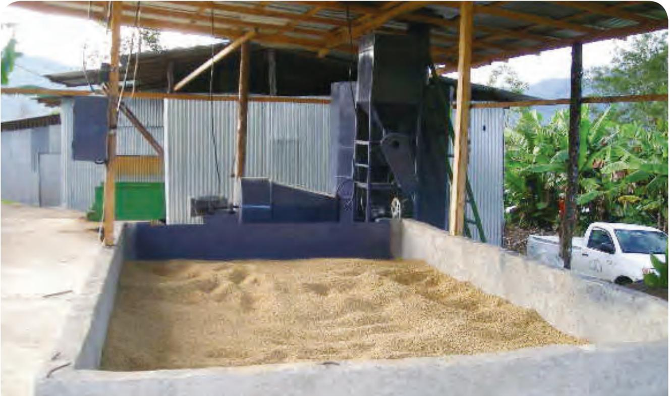
Equipo de secado mecánico con estática construida en block de cemento, para 40 fanegas (Micro beneficio Biocafé Oro, San Marcos de Tarrazú)
