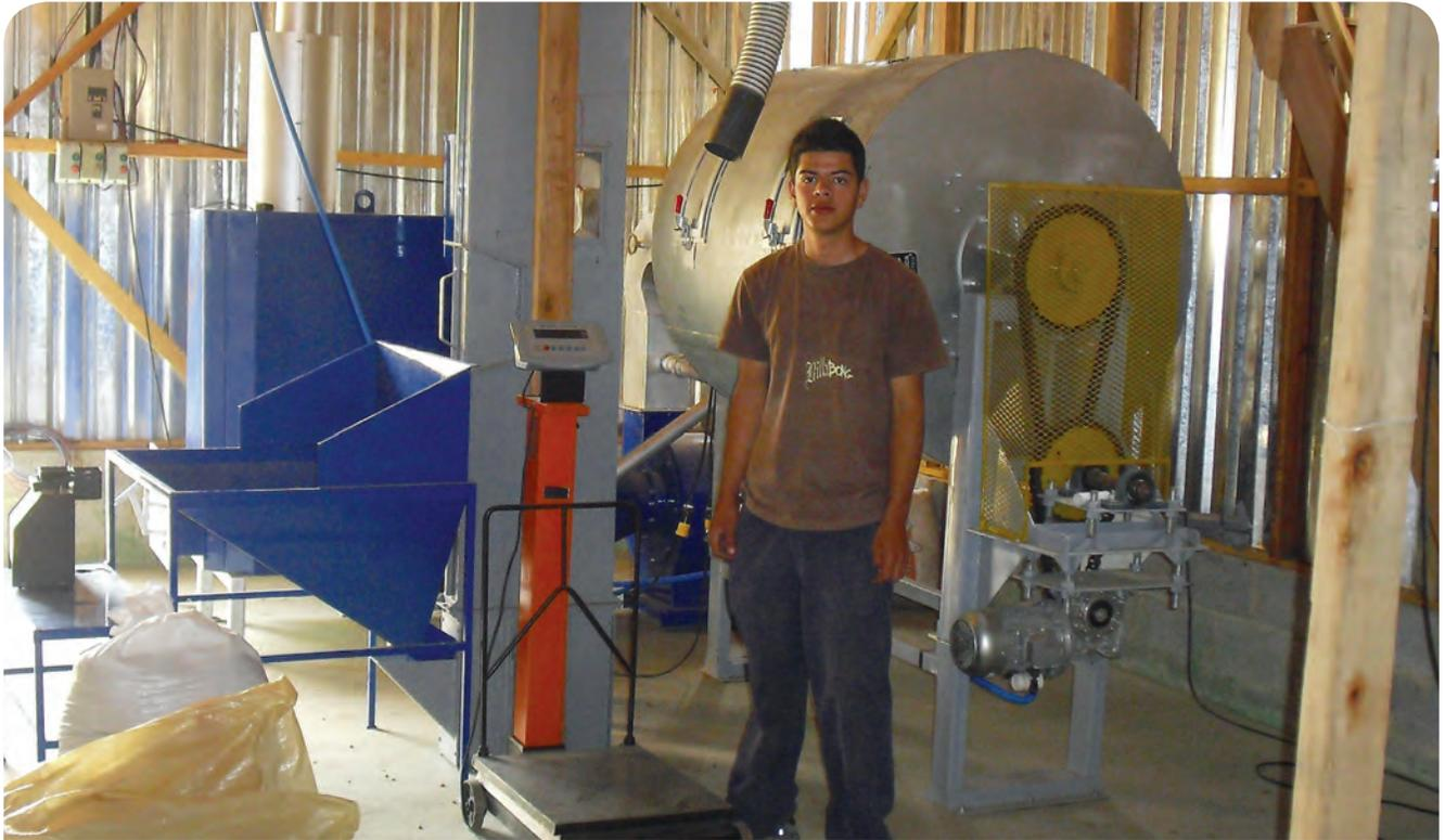
Secado mecánico con horno y guardiola para 10 fanegas
