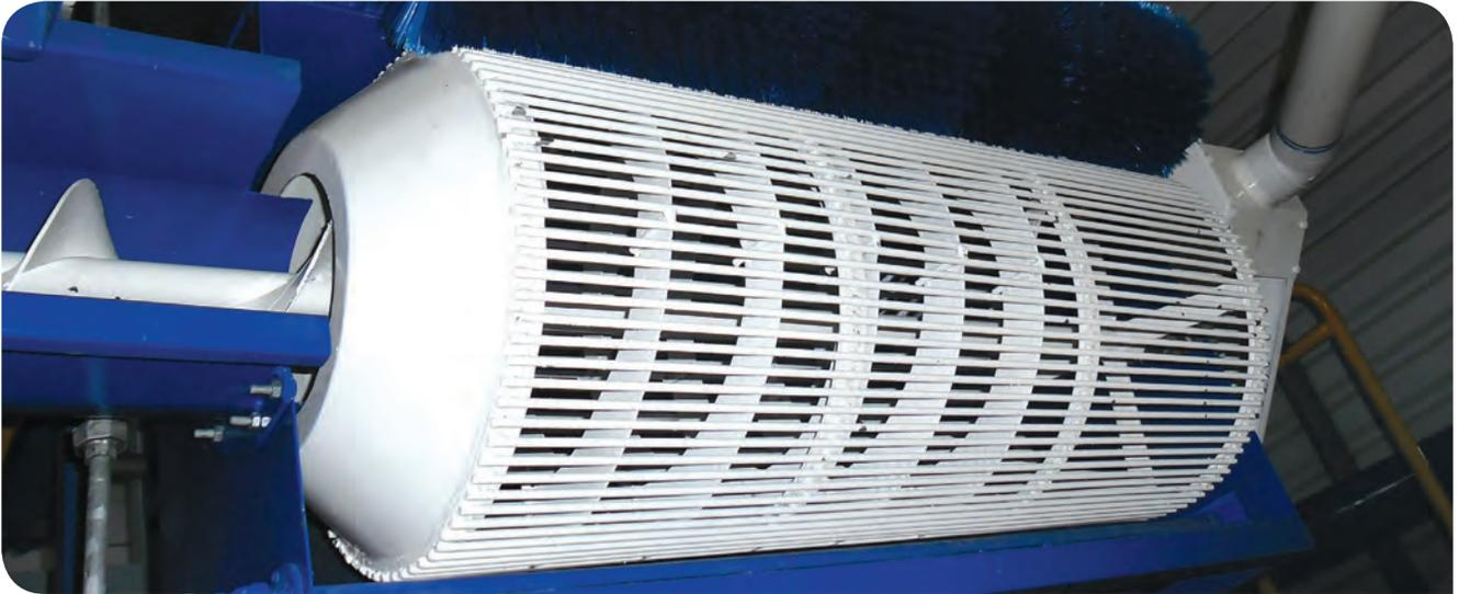
**G- Desmucilagadora:** una vez que el café despulpado pasa por la clasificadora, es conducido a un rodillo con canales helicoidales y estriados, donde se desprende el mucílago (miel) por la acción combinada de la fricción y presión con ayuda del agua.
