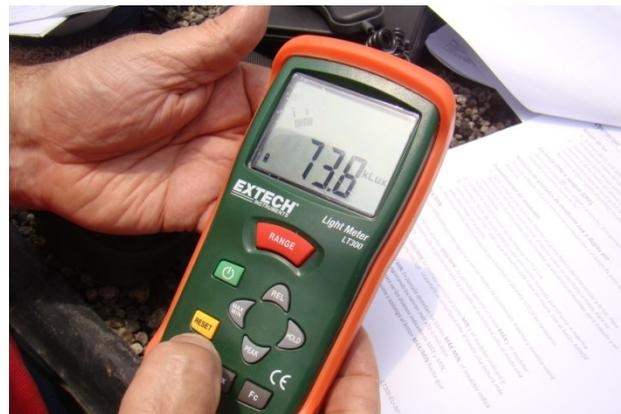
**La celda fotovoltaica recibe la cantidad de luz y da el resultado en una pantalla.**
