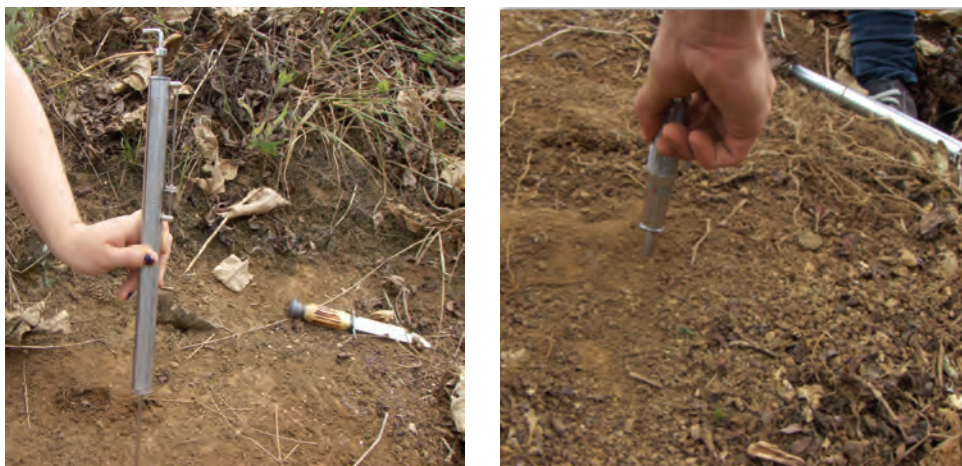
Fig. 2. Representación de la determinación de la resistencia a la penetración utilizando los penetrómetros “Chatillón” y “soil test” en un suelo cultivado con café en Juan Viñas, Costa Rica.
