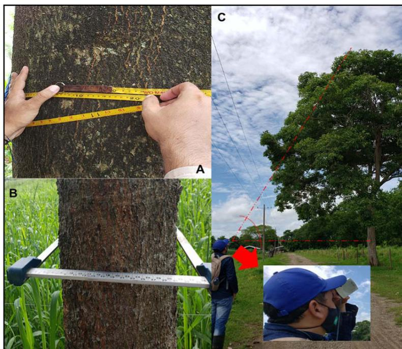
**Figura 2.** Evaluación en campo de variables dasométricas, diámetro a la altura del pecho (DAP), determinado con cinta métrica y forcípula (A y B) y altura total, determinada con el uso del clinómetro Suunto (C y D). Centro de Investigación Turipaná. Corporación Colombiana de Investigación Agropecuaria (AGROSAVIA). Cereté, Córdoba, Colombia. 2019-2021.
