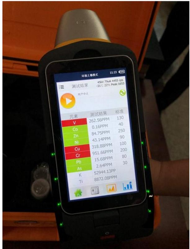
Lector portátil de metales pesados para uso en suelos y aguas con valores en ppm.
