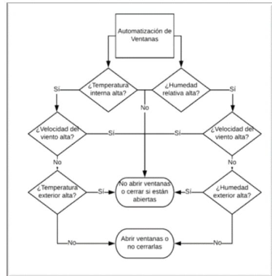
Figura 3. Esquema de automatización de un proceso.
