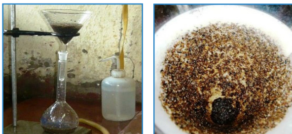
Figura 2. Fenwick Modificado (A) Balón aforado (B) Filtro con quistes (C). INTA, 2020.
