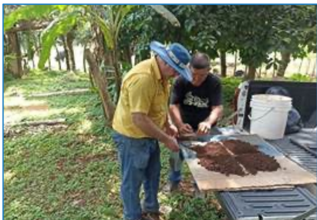
Figura 3. Ilustración del cuarteo de la muestra de suelos. INTA. Agosto, 2022.
