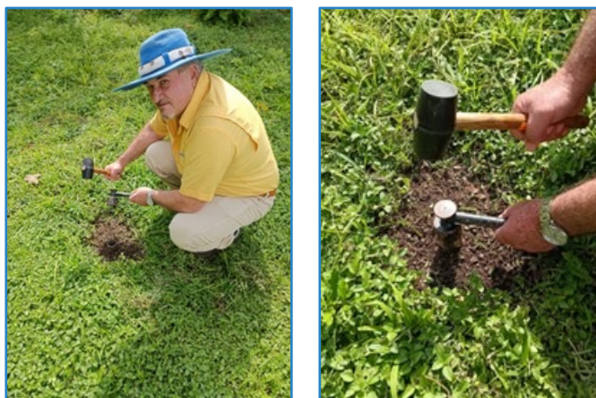
Figura 4. Ilustración de la extracción de la densidad aparente del suelo, con el método del cilindro para muestra indisturbada, se puede observar el muestreador y mazo de hule para no compactar. INTA. Agosto, 2022.
