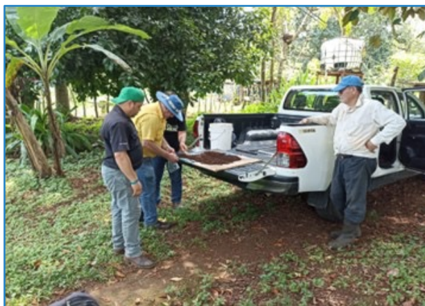
Figura 3. Ilustración del cuarteo de la muestra de suelos. INTA. Agosto, 2022.
