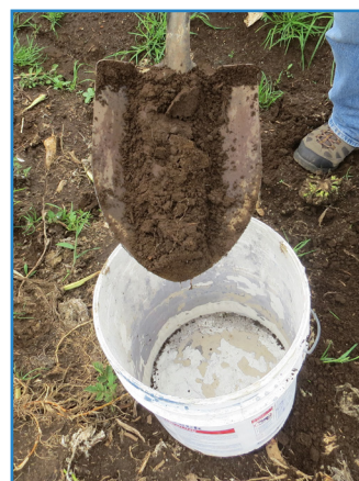
Figura 5. Utilización del palín o pala carrilera para la recolección de sub muestras. Santa Rosa de Oreamuno, Cartago, Costa Rica. 2019.
