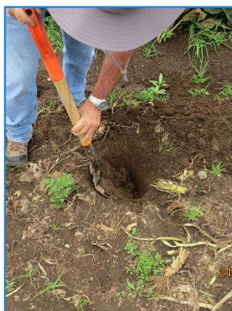
Figura 5. Utilización del palín o pala carrilera para la recolección de sub muestras. Santa Rosa de Oreamuno, Cartago, Costa Rica. 2019.
