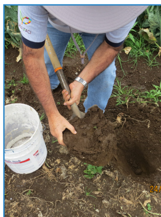
Figura 5. Utilización del palín o pala carrilera para la recolección de sub muestras. Santa Rosa de Oreamuno, Cartago, Costa Rica. 2019.
