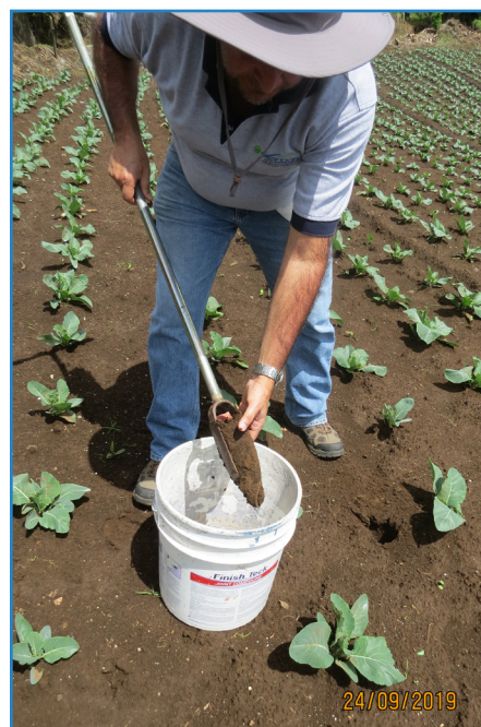
Figura 4. Uso del barreno para la recolección de sub muestras de suelo. Santa Rosa de Oreamuno, Cartago, Costa Rica, 2019.
