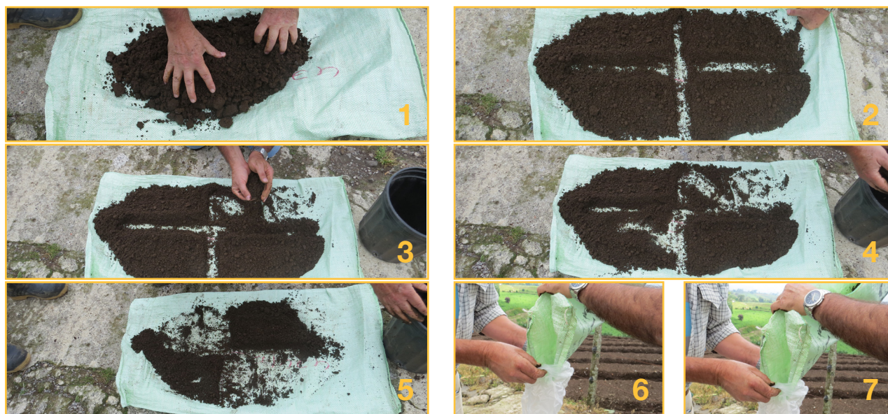
Figura 7. Método del cuarteo para homogenizar y disminuir de tamaño las submuestras de suelo. Santa Rosa de Oreamuno, Cartago, Costa Rica, 2019.a
